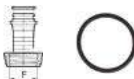
Juntas Tóricas para Espigas O-Rings for hose fittings OR pour raccords de tuyaux
