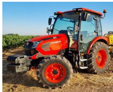
**Motor Stage 5 4H243T-TP5ACRDi 2.500cc 74 cv de potencia nominal (54,5 Kw)**
