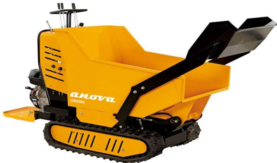
Carretilla con orugas con pala de autocarga de alta resistencia para un mejor funcionamiento a la hora de transportar elementos pesados por terrenos irregulares y con desniveles. Posee una caja tipo dumper para facilitar la acción de carga y descarga, un ángulo de descarga de 60°, capacidad giro cero, un freno tambor y palancas para mecanismos de giro.
