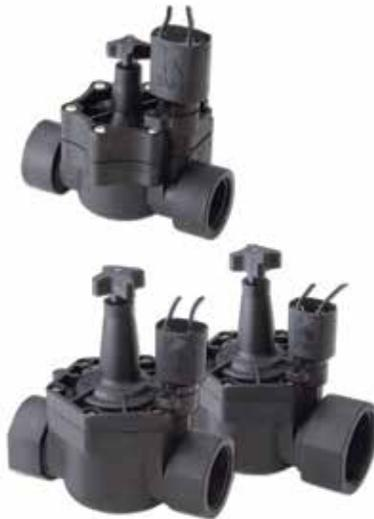
La válvula Serie Pro 200 es una válvula eléctrica repleta de características de durabilidad, diseñada para maniobrar aplicaciones de irrigación de hasta 13,8 bar. La construcción en nylon con fibra de vidrio y diafragma de caucho reforzado, asegura un largo y duradero funcionamiento.
