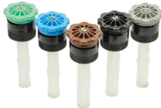
Esta boquilla totalmente ajustable con rosca hembra, se utiliza en los difusores series Pro-S y NP de K-Rain, así como en cualquier otro difusor con rosca macho en el mercado. Puede escoger entre configuraciones de 2,4; 3; 3,7; 4,6 y 5,2 m (8', 10', 12', 15' y 17').
