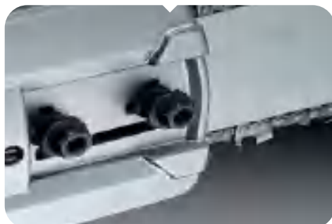
Tensado de cadena lateral con herramientas
